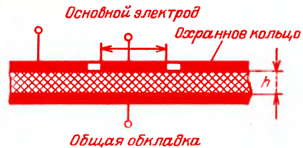
Рис. 7.8. Дисковый конденсатор с охранным кольцом для уменьшения краевых эффектов
