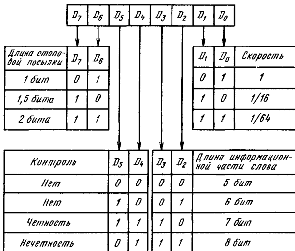
Рис. 7.6. Формат инструкции режима ПСА
